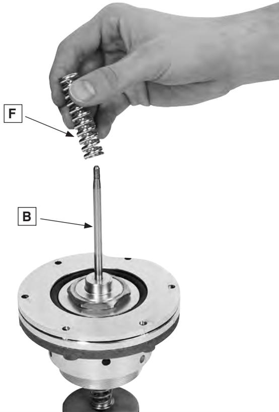
Снять регулировочную пружину **F** для нижнего давления отключения с толкателя **B** и очистить ее.
