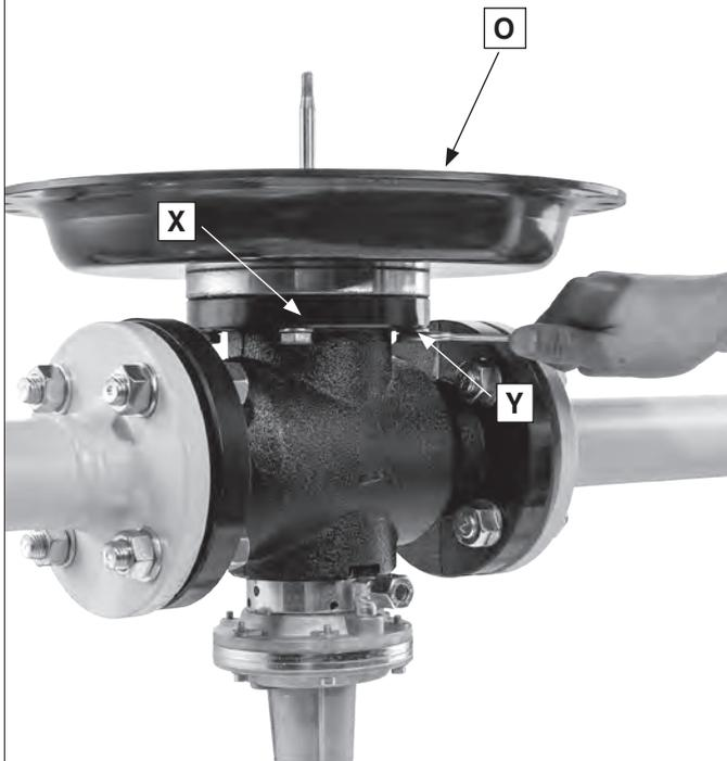
Снова затянуть четыре винта **Y**, зафиксировав таким образом чашу мембраны **O** на корпусе **X**.
