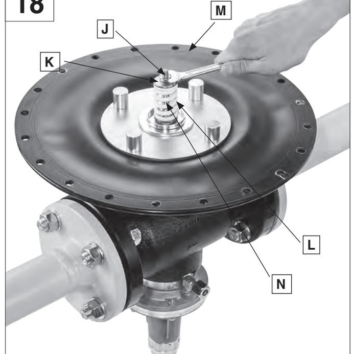
Снова надеть рабочую мембрану **M** на направляющий стержень **N**. Снова смонтировать предохранительную пружину **L**. Снова смонтировать пружинящую шайбу **K**. Затянуть до упора гайку **J** (М 8) при помощи рожкового ключа **13 мм**.
