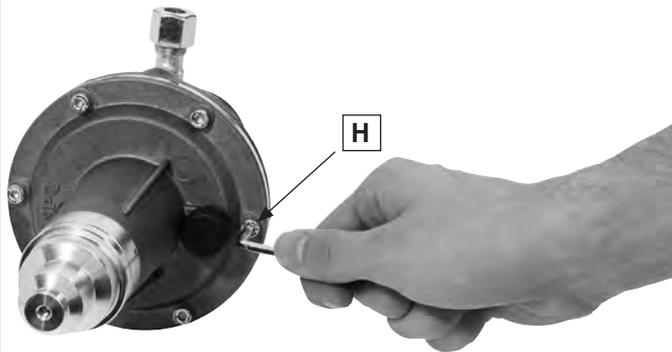
Вывинтить шесть винтов с шестигранным отверстием в головке **H** (M5) **I** при помощи торцевого шестигранного ключа 4 мм.
