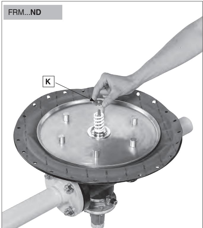
Удалить пружинящую шайбу **K**.
