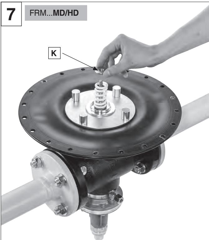
Удалить пружинящую шайбу **K**.
