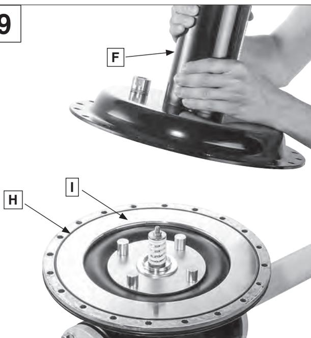
Снова установить диск мембраны **I** (только в исполнении HD) (комплект для технического обслуживания 2). Вставить новое кольцо круглого сечения **H** (только HD) (комплект для технического обслуживания 2) в кольцевую канавку диска мембраны **I**. Установить верхнюю крышку мембраны **F**.
