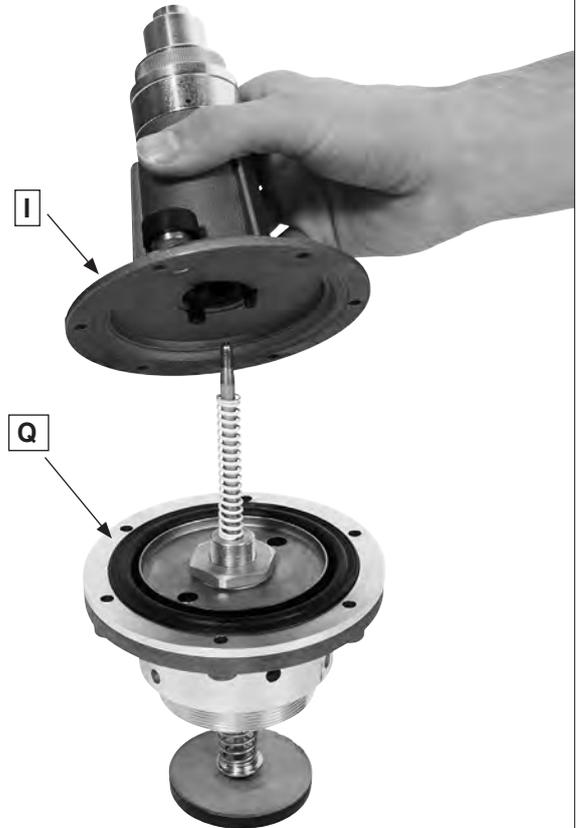
Снять крышку **I** ASE **Q**.
