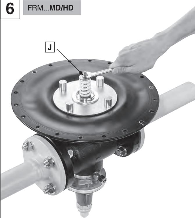
Отвинтить гайку **J** (M 8) при помощи рожкового ключа 13 мм.
