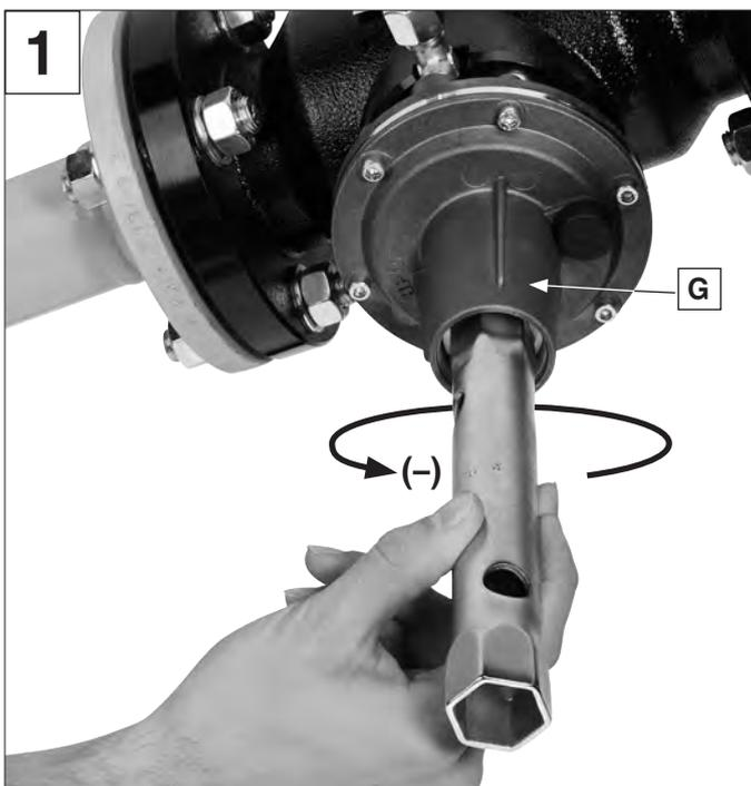
Вывинтить регулировочный винт В из пружинной стойки G при помощи трубного/торцевого ключа 22 мм.
