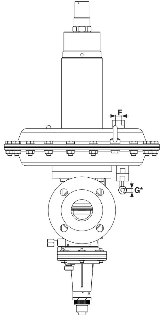
\* Герметичное резьбовое соединение 12L: GE 12 - 1/4 с резьбовым соединением M16 для труб 12 x 1,5
