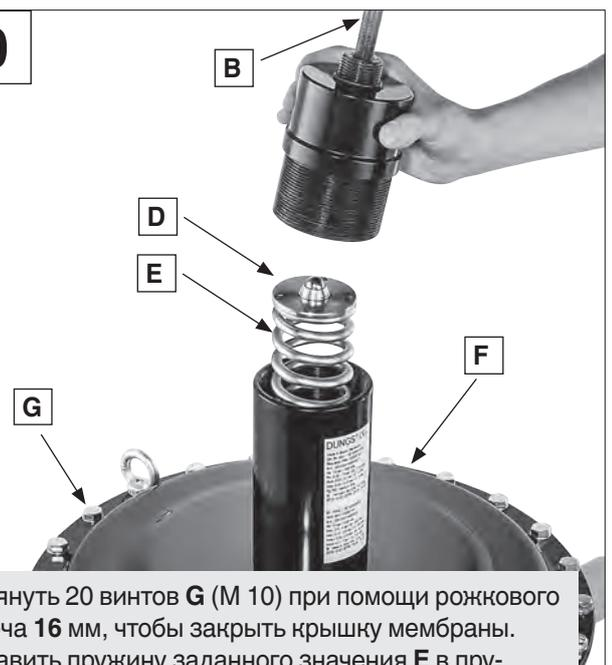
Затянуть 20 винтов **G** (М 10) при помощи рожкового ключа **16 мм**, чтобы закрыть крышку мембраны. Вставить пружину заданного значения **E** в пружинную стойку **F**. Поместить пружинящую шайбу **D** вместе с шаром на пружину. Ввинтить уплотнительный колпак **C** в пружинную стойку **F**. Ввинтить регулировочный винт **B** до достижения необходимого предварительного сжатия. Смонтировать защитный колпак **A**.
