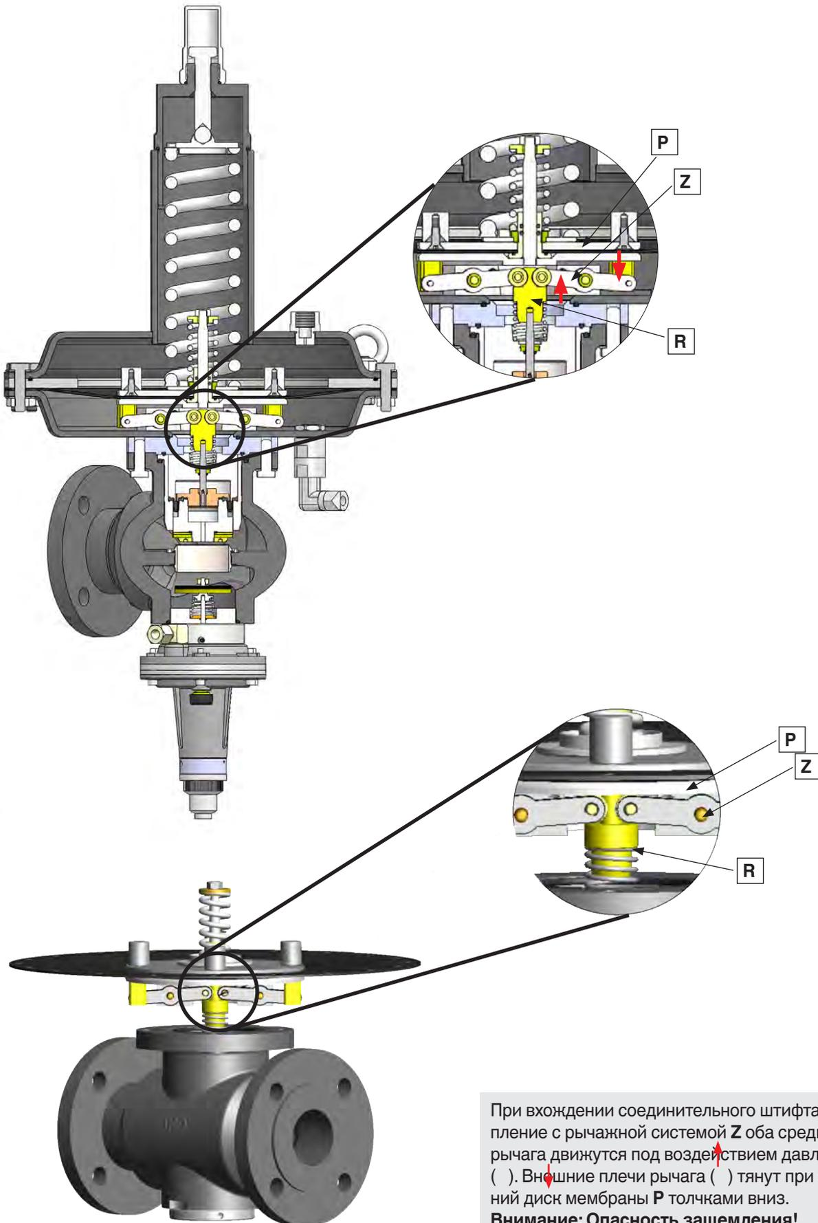
При вхождении соединительного штифта **R** в зацепление с рычажной системой **Z** оба средних плеча рычага движутся под воздействием давления вверх ( ). Внешние плечи рычага ( ) тянут при этом нижний диск мембраны **P** толчками вниз.
