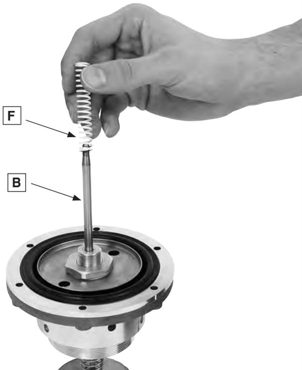
Снять регулирующую пружину **F** для нижнего давления отключения с толкателя **B** и очистить ее.
